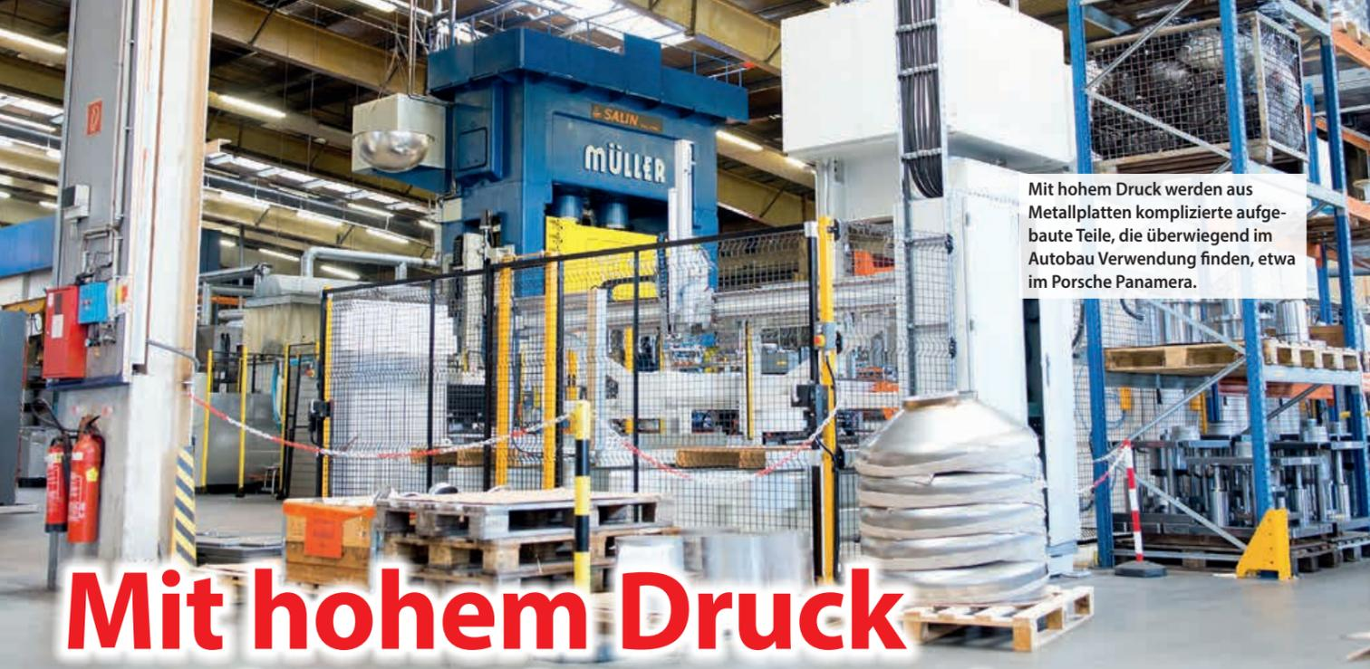
Mit hohem Druck werden aus Metallplatten komplizierte aufgebauete Teile, die überwiegend im Autobau Verwendung finden, etwa im Porsche Panamera.
